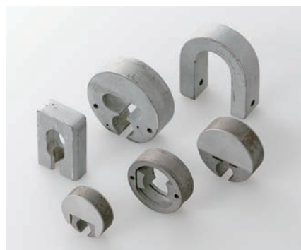
KS 磁石鋼(奥)。本多光太郎が1916年に発明した当時世界最高の磁石。研究費を寄附した住友吉左衛門にちなんで命名された。手前は1933年に発明された、さらに強力な新KS磁石鋼。
