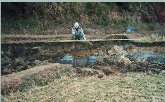
写真／阪神淡路大震災で淡路島北淡町(現淡路市)に出現した野島断層。人物側が相対的に隆起し右横にずれた。水田の畦が約2m斜めにずれている。
