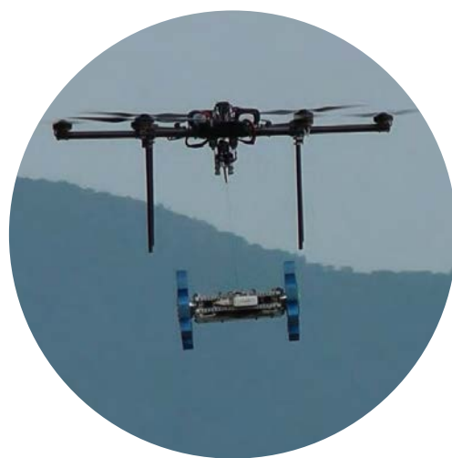
図1 / 飛行ロボットと切り離された移動ロボット
